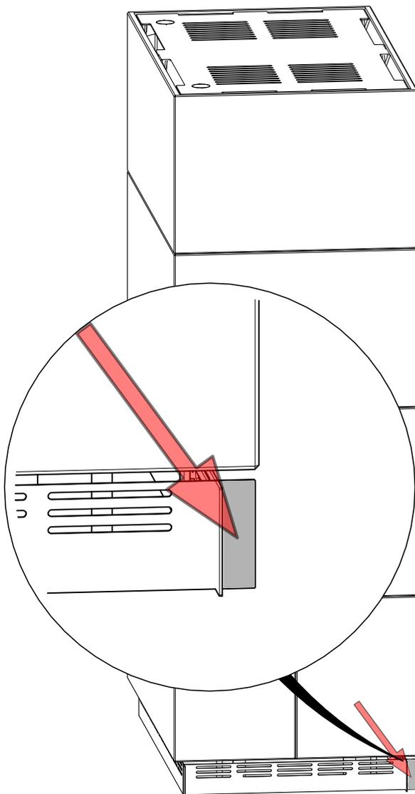
Die unteren Blenden sind so ausgeführt, dass diese bei direktem Anbau des BSK an eine Wand bündig mit dem BSK abschließen.
