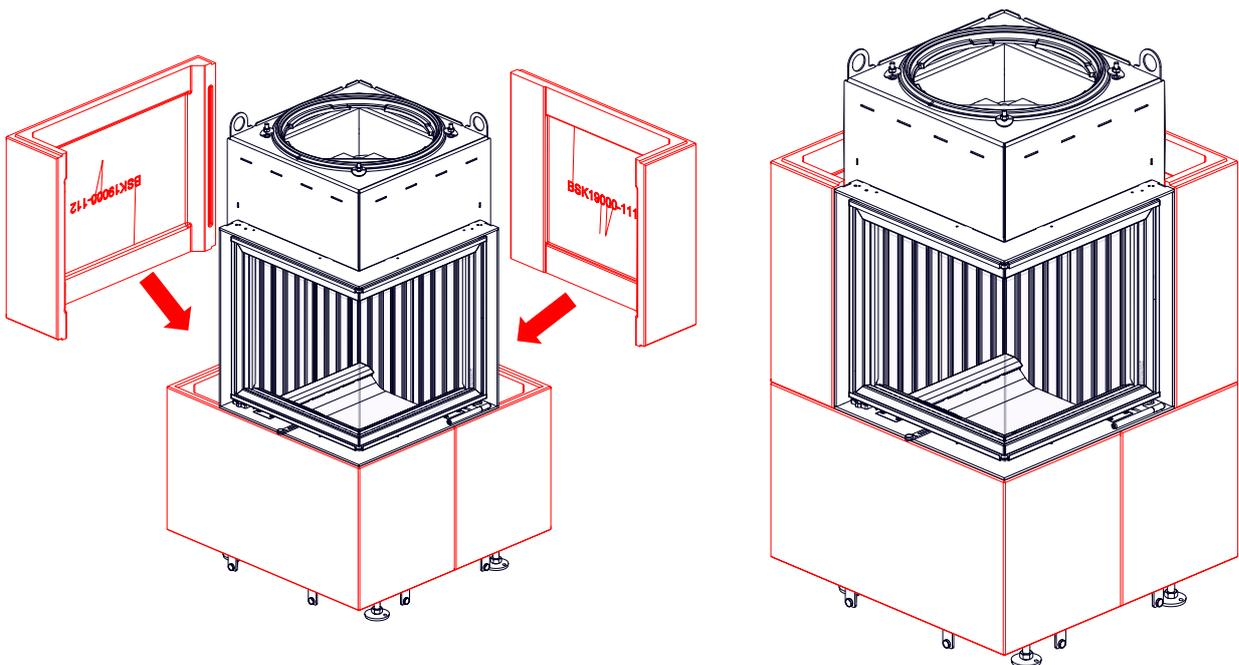
Vor Aufsetzen der Oberringe die Montage der Wärmetauschervariante vornehmen.
